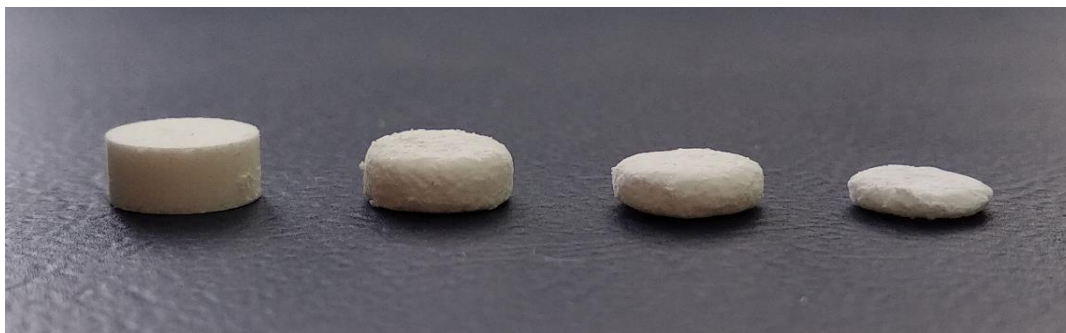
Slika 25. Tablete izrađene od obloženih granula pri pritisku kompresije od 104 MPa, pre i posle 10, 20 i 30 min ispitivanja raspadljivosti (s leva na desno)
