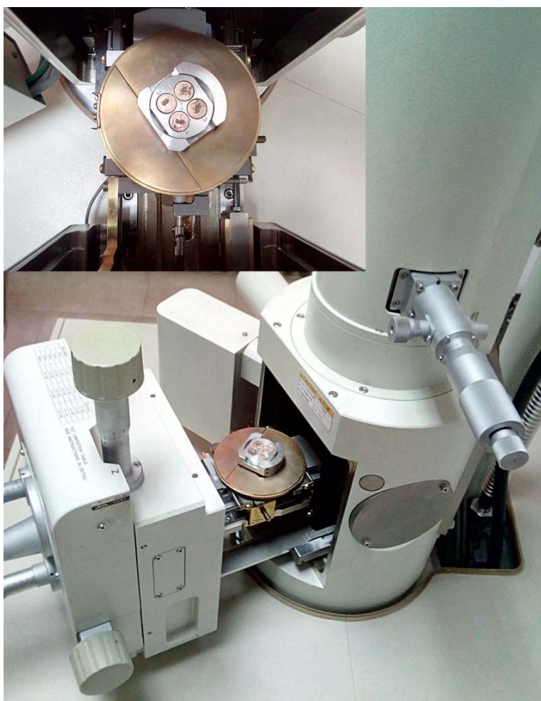
Slika 4.4. Analiza morfoloških karakteristika osušenih čestica sa inkapsulisanim uljem semenki jabuke u skenirajućem elektronskom mikroskopu (SEM)
