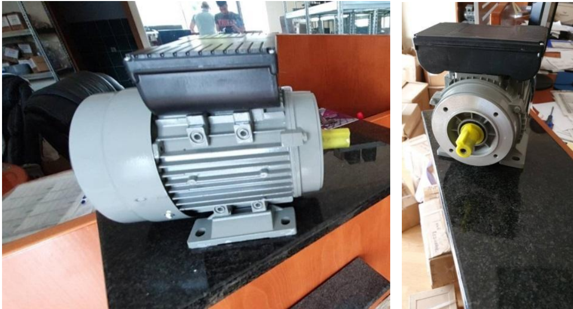
Слике 9 и 10. Монофазни мотор који производи 180 обртаја у минути.
