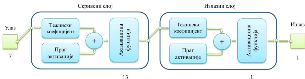
Слика 6.14. Вештачка неуронска мрежа конфигурирана за случај предвиђања потрошње воде у предшколским установама
