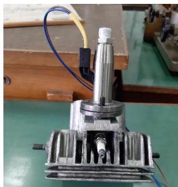
Слика 4.10. Цилиндарска глава са монтираном преткомором
