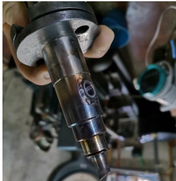
Слика 4.15. Преткомора након прегревања индуктивног давача
