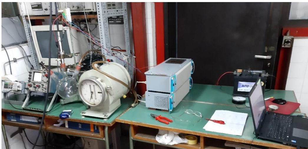
Слика 4.29. Мерна инсталација за одређивање карактеристика бризгача
