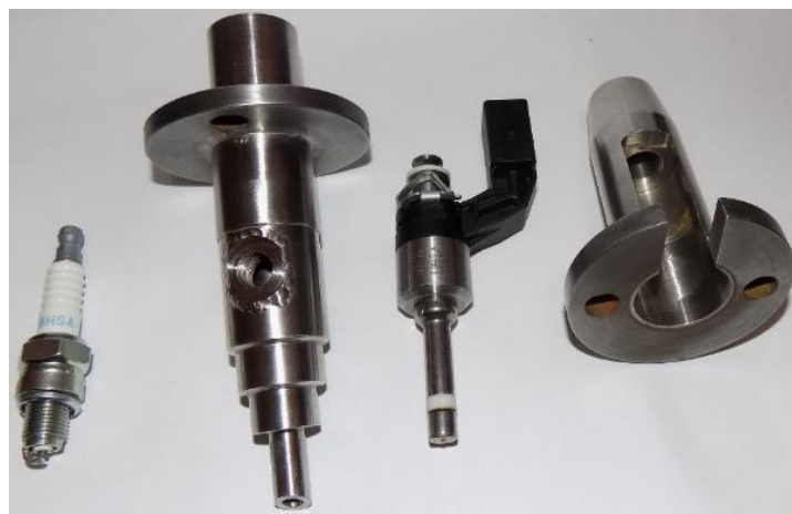
Слика 4.8. Крајњи изглед преткоморе са деловима
