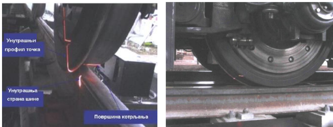
Слика 5.25 Снимак унутрашњег и спољног профила точка, венца, и површине котрљања
