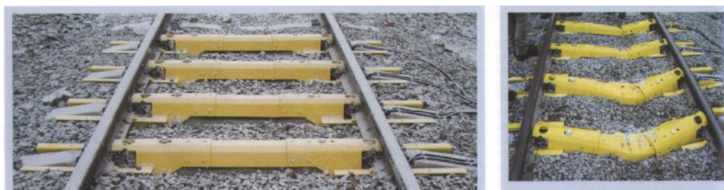
Слика 5.18 Инсталиран Аргос ниво 1 и исти након откривања исклизућа
