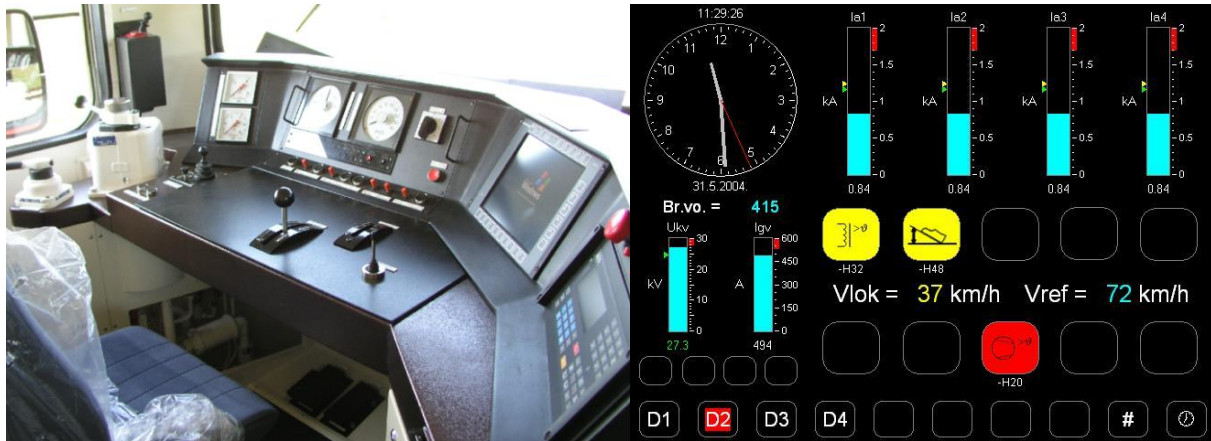
Слика 4.4 Изглед управљачнице на локомотиви серије ЖЖ 444 и приказ на дисплеју
