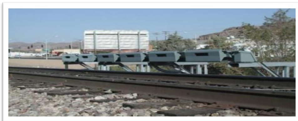
Слика 5.6 Запис звука сваког неисправног лежаја
