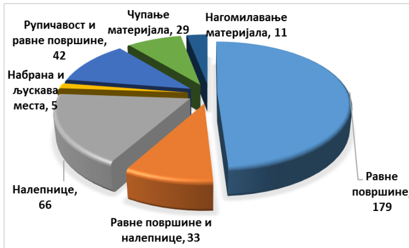
Слика 7.26 Дефекти на површини круга котрљања точка
