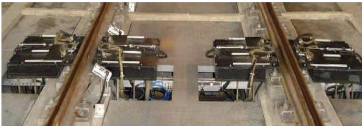
Слика 5.22 Систем за снимање стања кочних уметака
