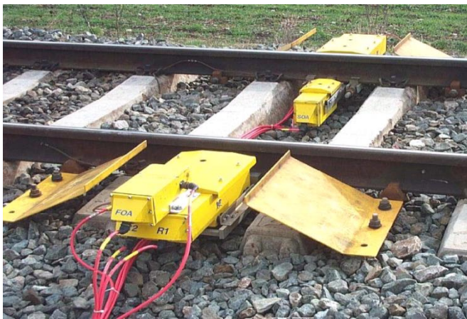
Слика 6.10 Уређај за детекцију прегрејаних лежишта осовинских склопова
