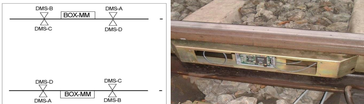
Слика 6.8 Распоред мерних трака и инсталација сензора на шину
