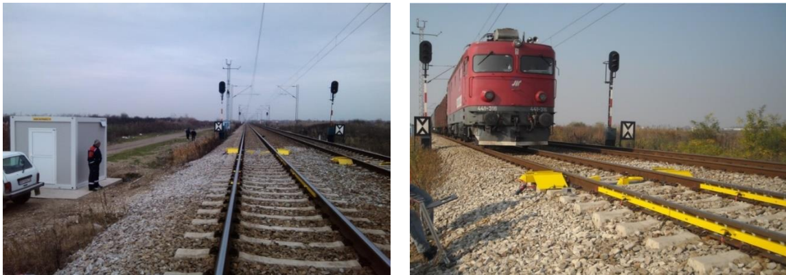
Слика 4.7 Стационарни систем за динамичку контролу техничког стања возних средстава, инсталиран у Батајница у km 22+993,66 (од km 22+951,66 до km 23+035,66)
