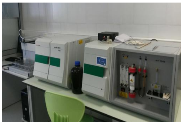
Slika 3.12. TOC/TN analizator (Analytik Jena, Multi N/C 3100)
