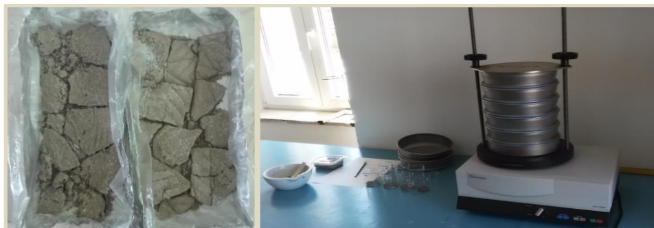
Slika 3.8. Liofilizovani uzorci sedimenta i njihovo prosijavanje (vibraciona tresilica sa sitima – Retsch, AS 200 digit)
