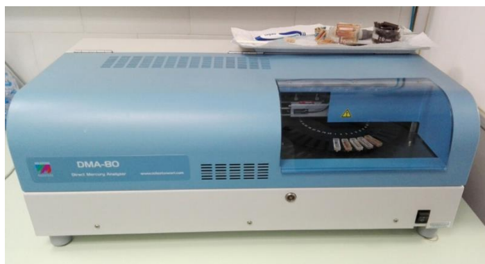
Slika 3.15. Direktni Hg analizator (Milestone, DMA-80)
