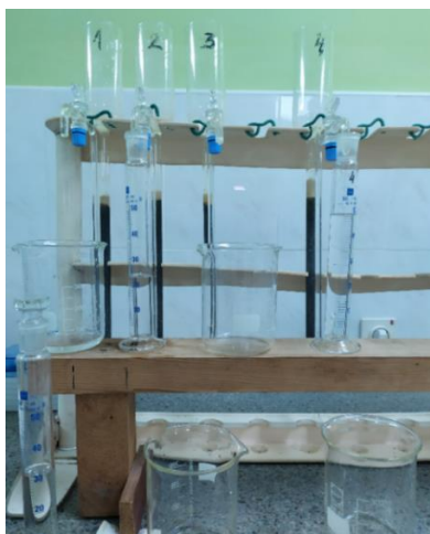
Slika 3.10. Priprema uzoraka morske vode za analizu nitrata (redukcione kolone)
