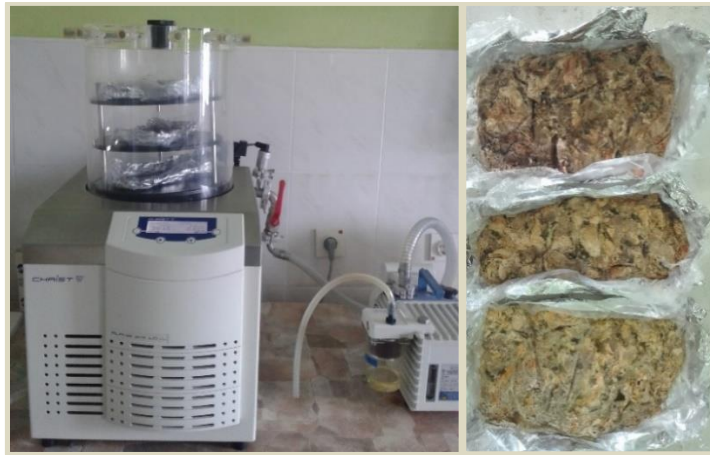
Slika 3.5. Liofilizator (CHRIST, Alpha 2–4 LD plus) i izgled liofilizovanih uzoraka dagnji
