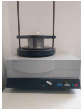
Slika 3.6. Vibraciona tresilica (Retsch, AS 200 digit) sa kugličnim mlinom
