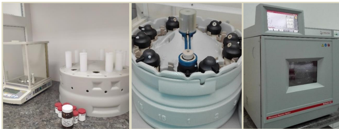
Slika 3.9. Priprema uzoraka za mikrotalasno razaranje i mikrotalasna peć (Anton Paar, Multiwave PRO)
