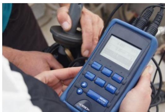
Slika 3.3. Multiparametarska sonda (WTW Multi 350i)
