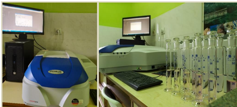
Slika 3.11. Određivanje koncentracije nutrijenata na UV/VIS spektrofotometru (Analytik Jena, Specord 250 Plus)
