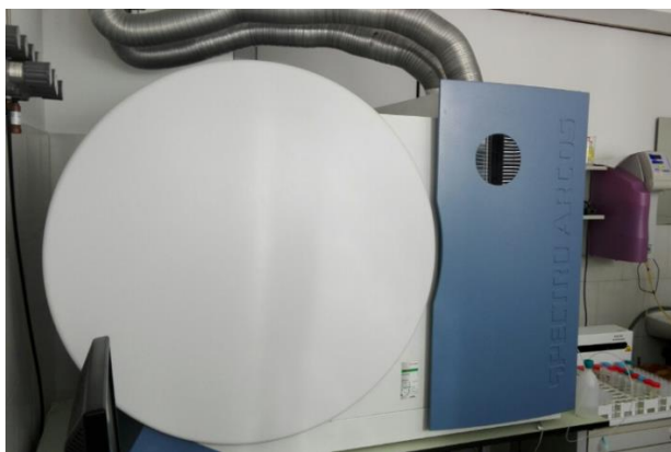
Slika 3.13. ICP-OES (Spectro Arcos FHE12)
