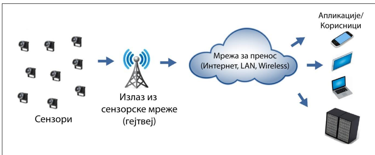
Слика 9. Организација IoT система
