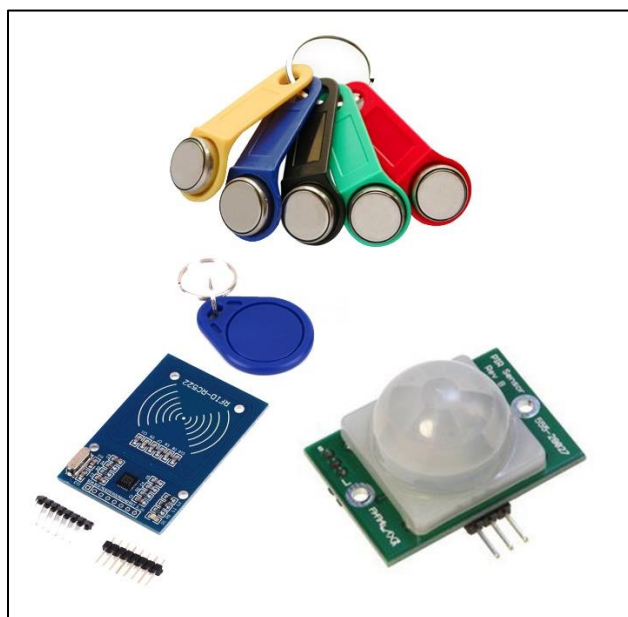
Слика 6. I-Buttons чипови, RFID таг и сензор покрета
