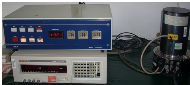
Slika 18. Uređaj za određivanje dielektričnih termičkih svojstava polimera
