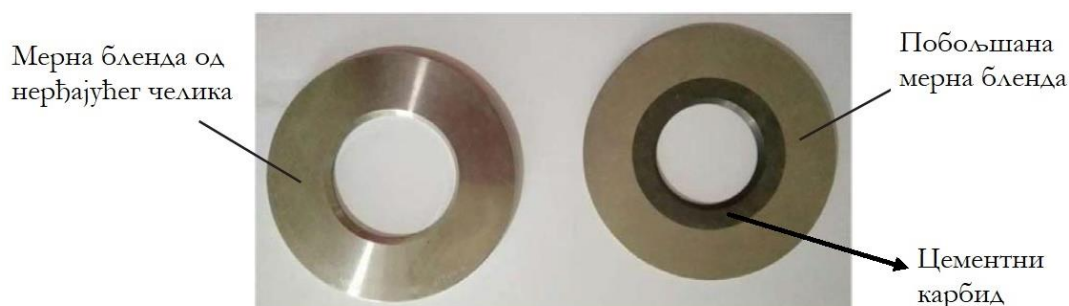
Слика 24 Конвенционална и побољшана мерна бленда, [34]
