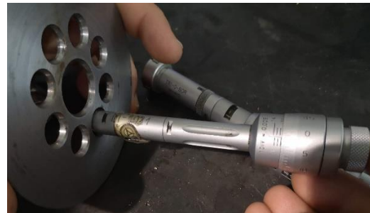
б) Мерење димензија отвора БВО
