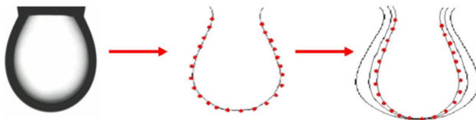
Slika 4. Šematski prikaz softverske obrade slike PAT metodom: slika viseće kapi, određivanje koordinata profila kapi i skup teoretski odogovarajućih profila eksperimentalnim podacima (Javadi i sar., 2013).
