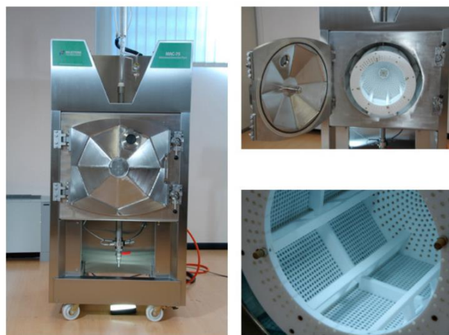
Slika 10. Polu-industrijski mikrotalasni ekstraktor sa 4 magnetrona ( 4 \times 1500 W, 2450 MHz) (Ciriminna i sar., 2016)
