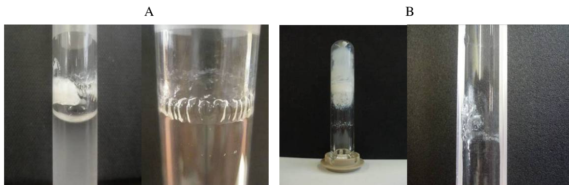
Slika 3.3. Stepen korozije kao i prisustvo nerastvornih silikata iz stakla vezanih na površinu zidova Pyrex mikrotalasnih reakcionih sudova (A, Biotage - 20 % KOH, 190 °C, 2 h; B, Anton Paar - 20 % KOH, 210 °C, 2 h).
