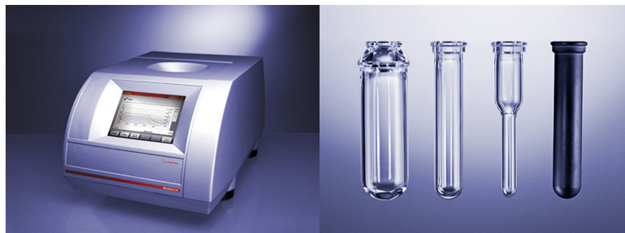
Slika 2.12. Anton Paar Monowave 300 mono-modni mikrotalasni reaktor i reakcioni sudovi namenjeni za rad u mikrotalasnoj peći.
