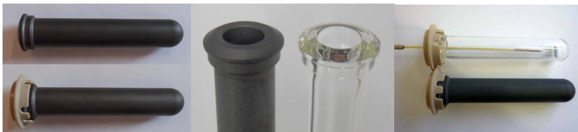
Slika 2.17. Reakcioni viali izrađeni od silicijum-karbida (SiC) za mono-modni mikrotalasni reaktor Anton Paar Monowave 300.
