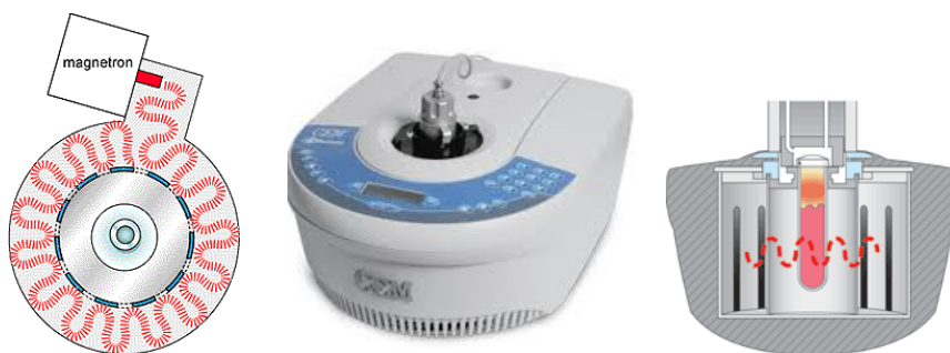
Slika 2.11. CEM Discover BenchMate sa kružnim tokom mikrotalasnog zračenja i šemom mikrotalasnog reaktora.
