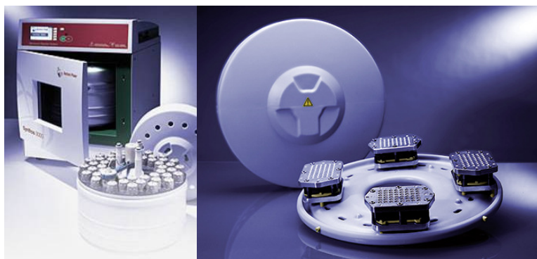
Slika 2.13. Anton Paar Synthos 3000 sa rotorom kapaciteta zagrevanja 48 reakcionih smeša paralelno ili četiri SiC ploče (4 x 20 uzoraka).
