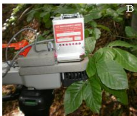
Slika 3.11.: Određivanje fizioloških parametara pomoću LC pro+ aparata na listovima biljaka smrče (A) i bukve (B)
