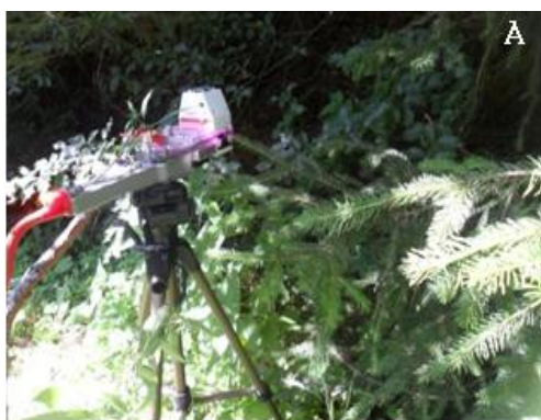
Slika 3.11.: Određivanje fizioloških parametara pomoću LC pro+ aparata na listovima biljaka smrče (A) i bukve (B)
