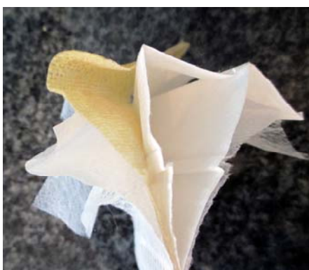
Слика 17. Пресек филтрирајуће полумаске
