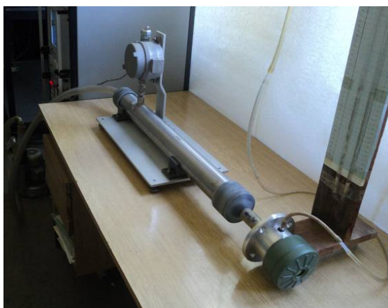
Слика 37. КФ прикључен на апаратуру за испитивање отпора КФ при удисању
