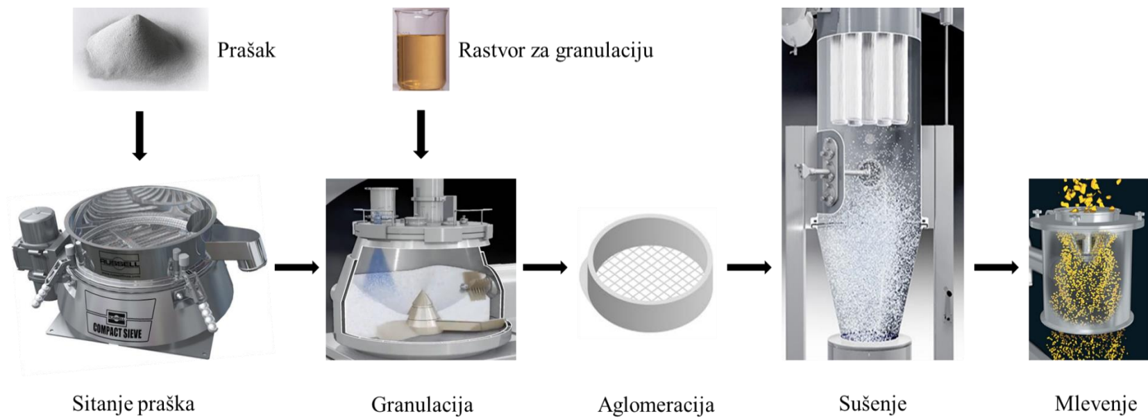
Slika 12. Procesni koraci u postupku visoko-smicajne vlažne granulacije (preuzeto i prilagođeno iz Finex Ltd, 2018; FriendCorporation, 2019; GlattGroup, 2019; GlattGroup, 2018)
