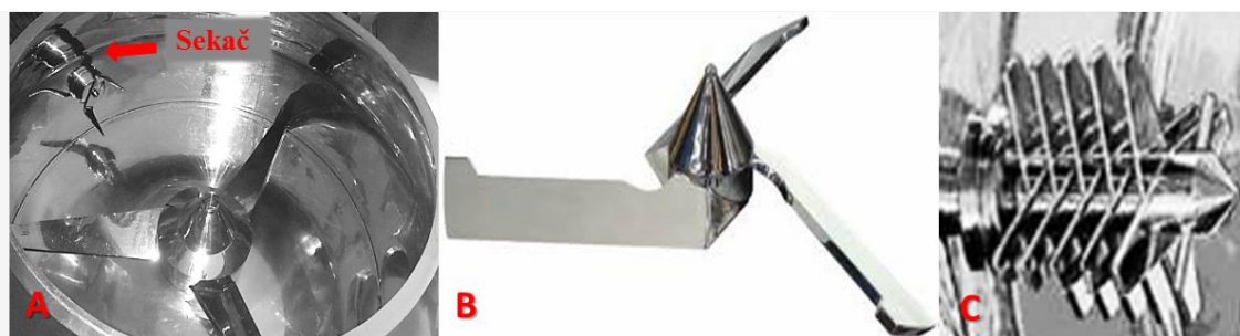
Slika 13. Primeri dizajna mešalice i sekača koji se koriste kod visoko-smicajne mešalice: A. stiardni oblik mešača sa sekačem u obliku slova U; B. M8 dizajn mešača; C. sekač sa višestrukim oštricama (preuzeto i prilagođeno iz Yadav i sar., 2010)
