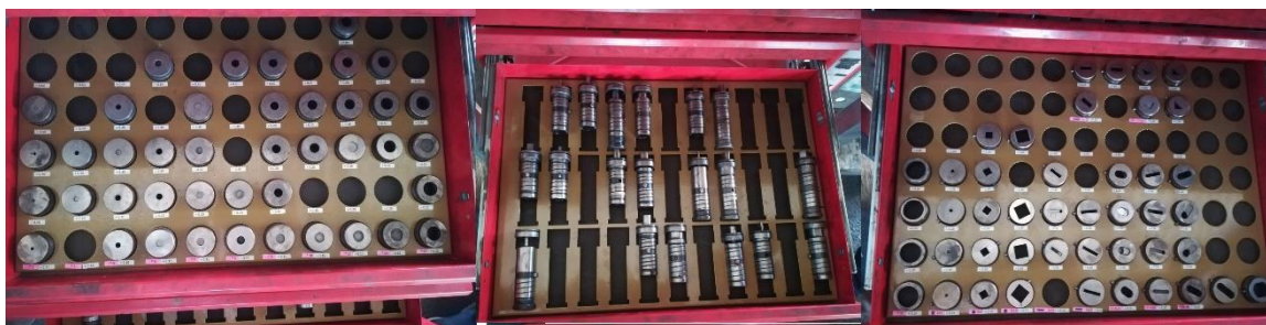
Slika 6.33 Alat probijačice - sektor limarije pre i posle unapređenja
