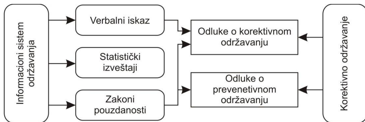
Slika 3.3. Šematski prikaz metode „Održavanje prema radu“ (OCM)
