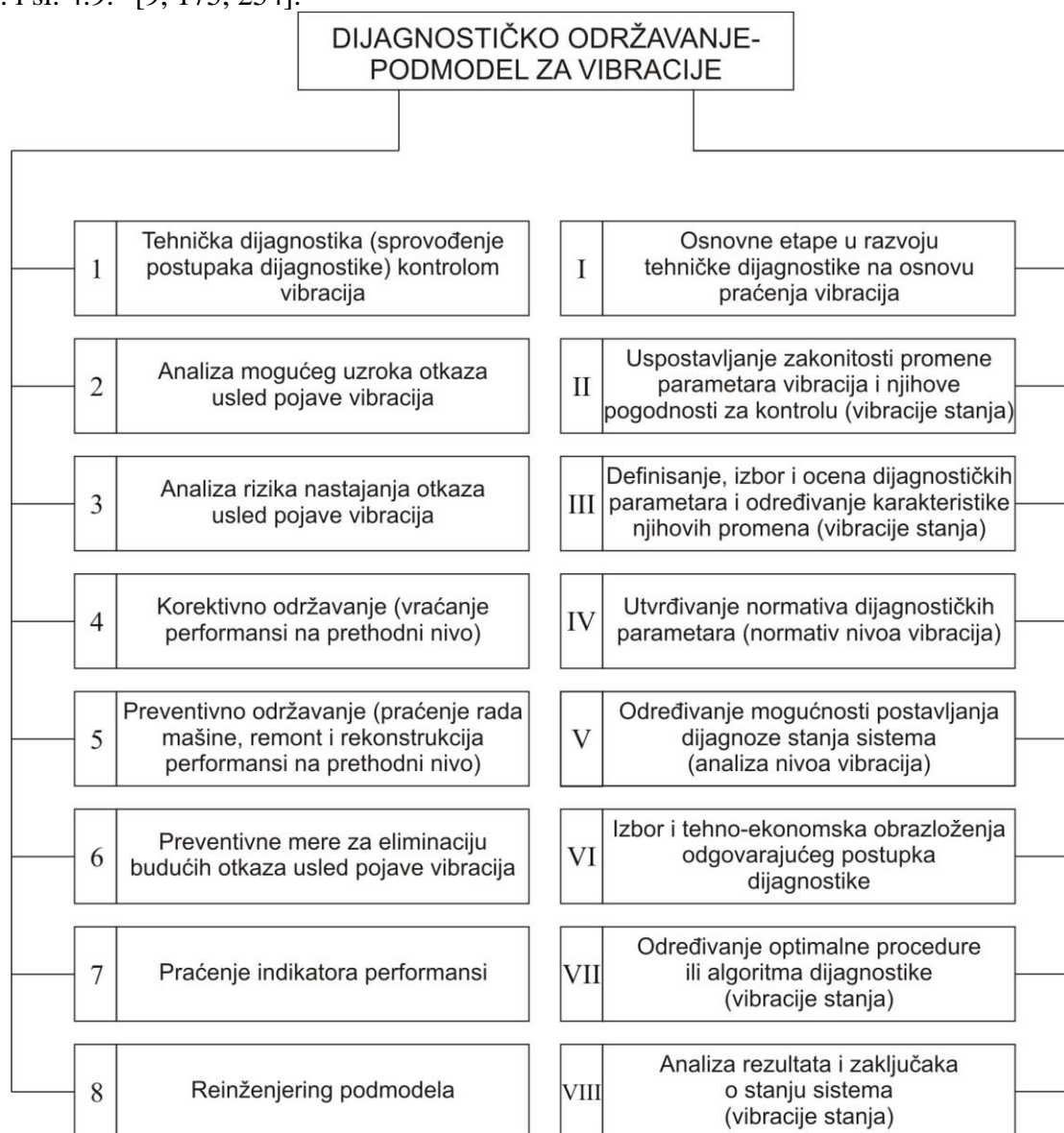
Slika 4.8. Model dijagnostičkog održavanja – podmodel za vibracije
