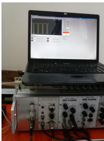
Slika 4. Galvanski stimulator koji je generisao pravouglo impulse
