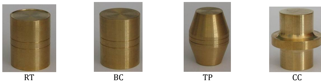
Slika 2.14 Modeli deformisanja primenjeni za određivanje DGD-a [25]
