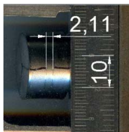
Slika 4.14 Prikaz merenja deformacije po z osi
